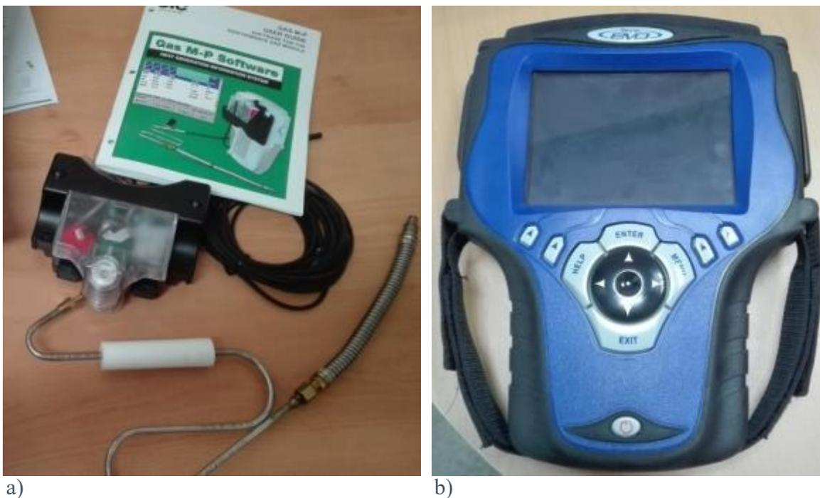
**Figura 2.0** Sistema de medición de gases contaminantes a) Escáner Automotriz Genesys NGIS b) Modulo de Análisis de Gases M-P. Fuente: *Elaboración propia*
